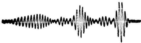
Fig. 4. — Réponse du guide à l'excitation simultanée des modes 1, 3 et 5. On note la dispersion des 3 modes, du plus rapide au plus lent.
