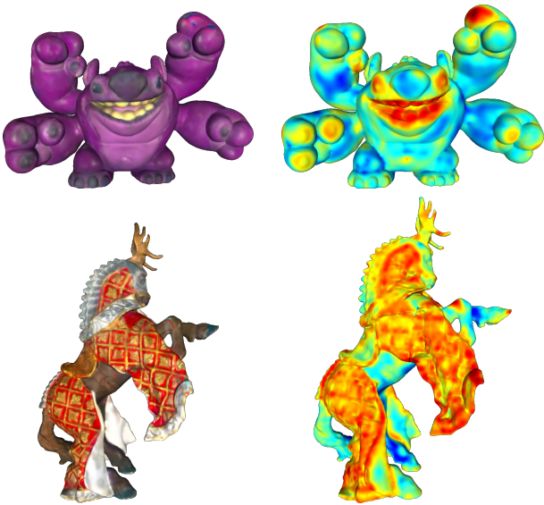
FIGURE 1 : Résultats de détection de la saillance colorimétrique multi-échelle sur deux maillages de la base GREYC Colored 3D Meshes Database . La première colonne présente les maillages 3D de référence. La seconde colonne présente leur saillance colorimétrique multi-échelle. Les couleurs chaudes représentent des degrés de saillance importants alors que les couleurs froides représentent de faibles degrés de saillance.
