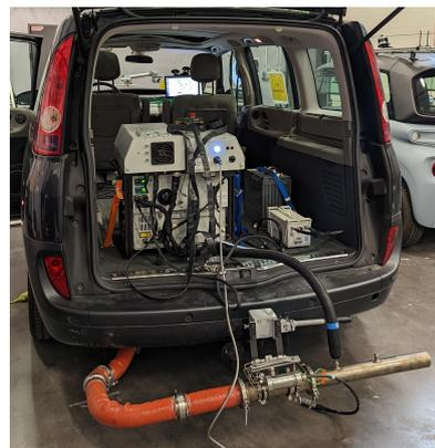
FIGURE 2 : PEMS installé à l'arrière du véhicule de test pour la mesure des émissions en temps réel.
