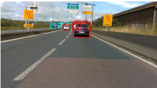
FIGURE 3 : Détection de véhicules avec orientation : exemples issus de notre jeu de données. Véhicules entrants (en bleu) ; Véhicules sortants (en rouge).
