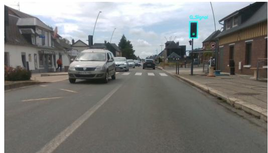
FIGURE 4 : Détection des feux de circulation avec des exemples de notre jeu de données : Feu vert détecté.
