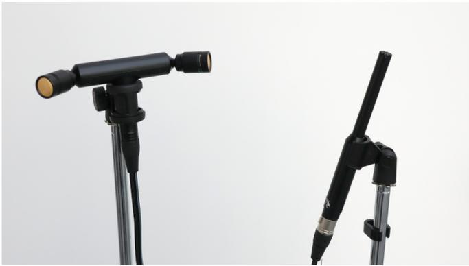
FIGURE 1 : Couple ORTF et microphone de mesure.
