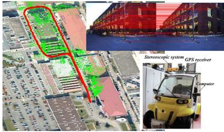
FIGURE 3 – Gauche : en rouge la trajectoire et en vert les amers 3D reconstruits par OV ; Droite (haut) : paire stéréoscopique et points appariés ; Droite (bas) : véhicule instrumenté
