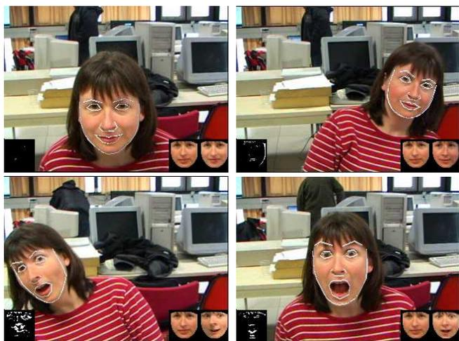
FIG. 3: Suivi de la pose et des mouvements faciaux utilisant une apparence faciale calculée à la volée ; images 75, 215, 470 et 1310 extraites d'une séquence vidéo.  $\alpha = 0.2$ ,  $h = 0.006$
