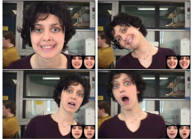
FIG. 1: Suivi de la pose et des mouvements faciaux, images 085, 366, 615 et 651. Sur chaque image, la forme dessinée correspond à l'état estimé du visage; les textures modèle et image  $\mathbf{g}_{modele}(\mathbf{c}_t)$  et  $\mathbf{g}_{image}(\mathbf{p}_t, \mathbf{c}_t)$  sont présentées dans le coin en bas à droite.  $h = 0.006$
