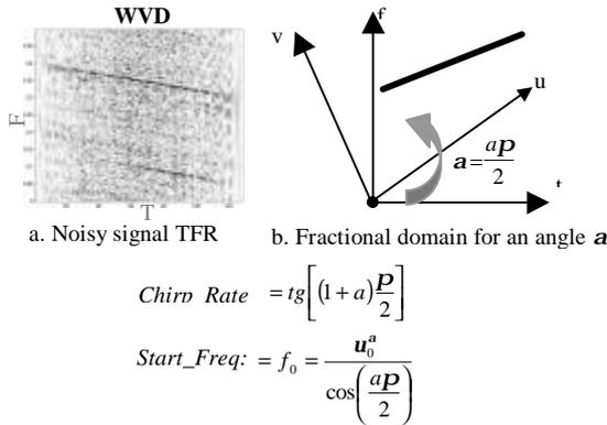
FIG. 2 : Chirp parameter estimation using FRFT
