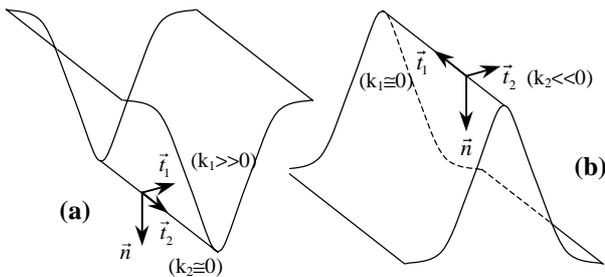
Figure 2 : (a) Vecteurs courbures principaux sur sillons, (b) Vecteur courbures principaux sur gyri.
