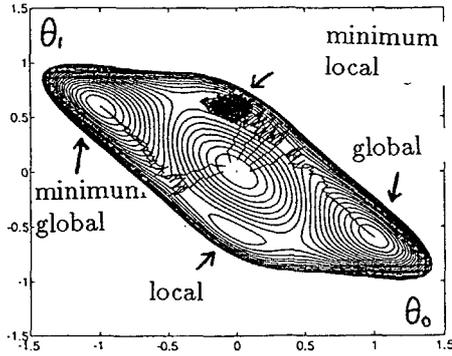
Figure 2: Coût et trajectoires de l'algorithme de Godard
