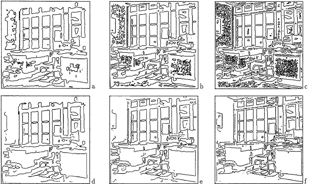
Figure 5: a), b) et c) images de contours obtenues à différentes échelles ( $\alpha = 0.5, 0.7, 1.0$ ). d), e), f) images de contours après élimination des faux contours engendrés par le bruit et les double marches. Les seuils bas et haut déterminés expérimentalement pour l'image à plus haute échelle valent 2 et 4, les seuils calculé automatiquement pour les deux autres images valent respectivement 12 et 24 pour l'image (e), 28 et 53 pour l'image (f).
