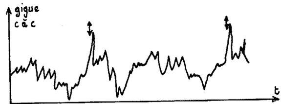
FIG.5. - Variations de la gigue en fonction du temps
