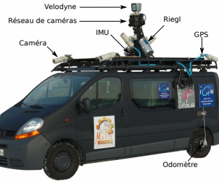
Figure 6. Vue d'ensemble du véhicule d'acquisition Stéréopolis
