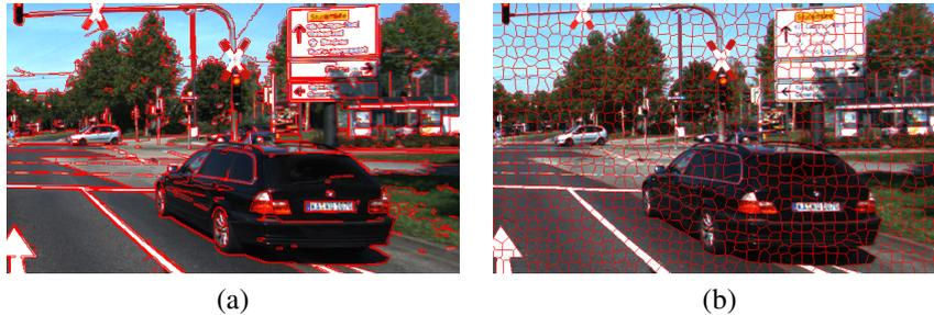
Figure 2. (a) Sur-segmentation obtenue par la méthode de Felzenszwalb et Huttenlocher (2004). (b) Sur-segmentation calculée à partir de l'algorithme SLIC (Achanta et al., 2012)
