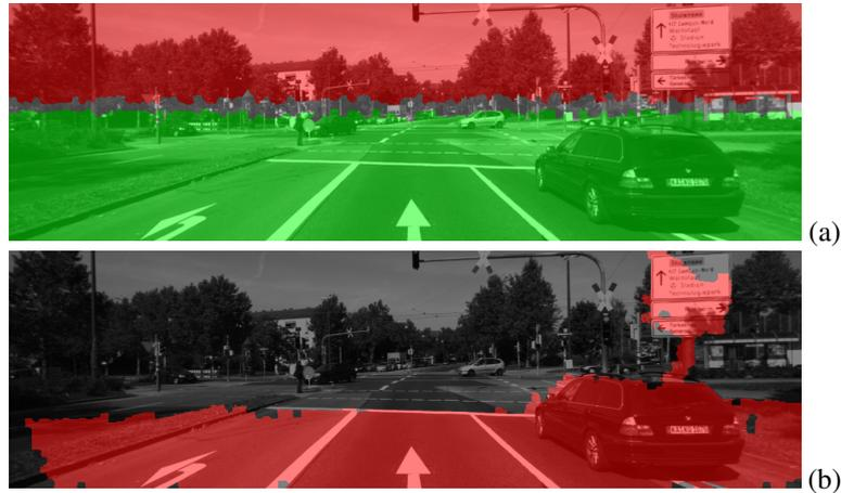
Figure 5. (a) Les segments rouges correspondent à ceux qui sont entièrement au-dessus de la ligne d'horizon, ils ne peuvent donc pas correspondre au ciel. Les segments verts sont sous la ligne d'horizon, ils ne peuvent donc pas correspondre au sol. (b) Les segments rouges correspondent à ceux dont la disparité moyenne est supérieure à 24 pixels. Ils ne peuvent donc pas correspondre au ciel
