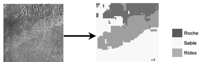
Figure 13. Classification sur des fenêtres de  $32 \times 32$  pixels.
