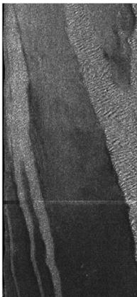
Figure 18. Variation lente de luminosité dû à un changement progressif de sédiment.
