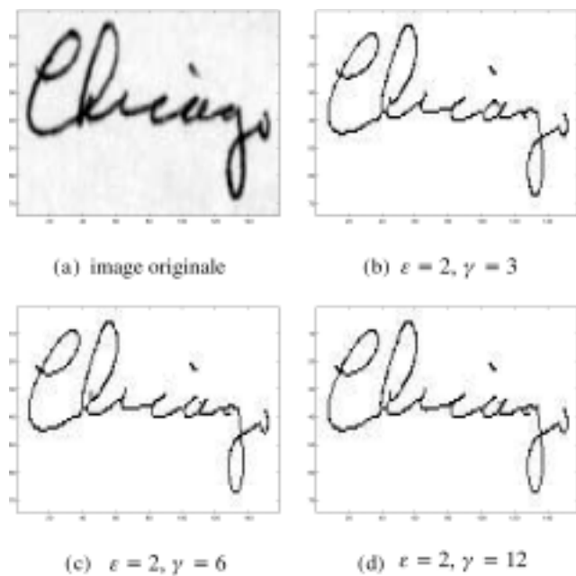
Figure 9. Amincissement d'image avec des paramètres \epsilon et \gamma du KCS \rho_{\epsilon,\gamma} différents lors du prétraitement.
