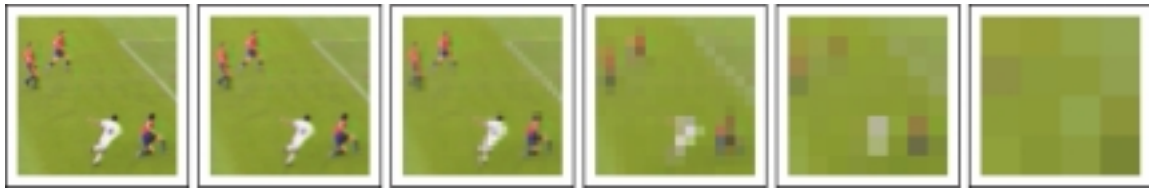
Figure 6. Représentation d'une image à différentes résolutions, de la résolution originale r = 0 (à gauche) à r = r_{\text{max}} = 5 (à droite).
