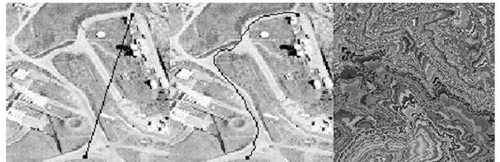
Figure 3. – Minimum Global d'un contour actif par propagation de front. Le contour minimal entre les deux points donnés à gauche est trouvé sur l'image du centre. A droite on voit la fonction de coût à partir du point de départ. Remarquer la propagation plus rapide le long des routes.
