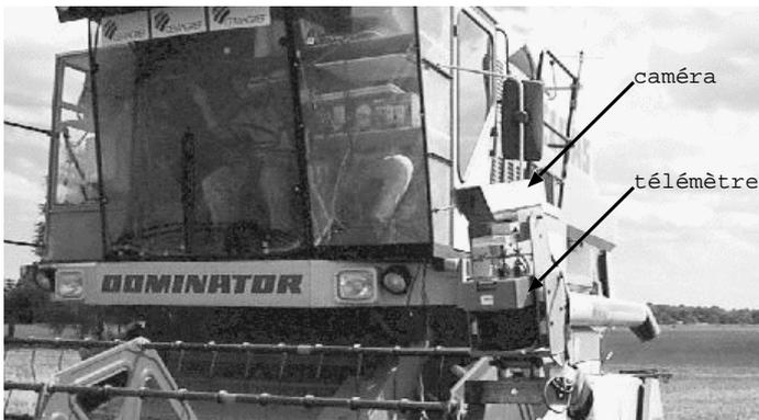
Figure 2. – Positionnement du capteur sur la moissonneuse batteuse.
