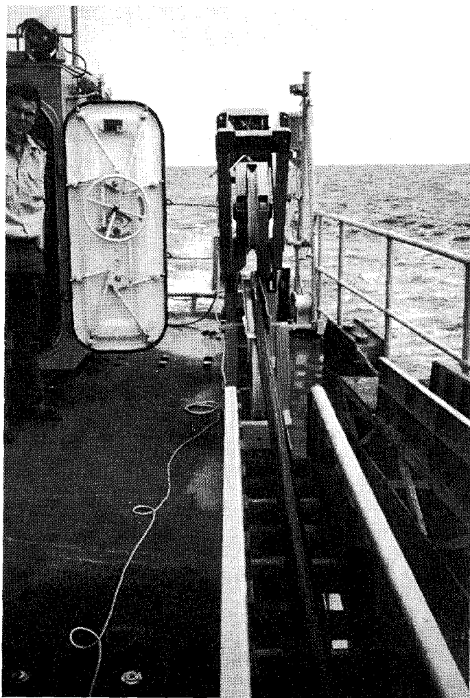
Photo 4. — Mise à l'eau d'une antenne linéaire remorquée.
