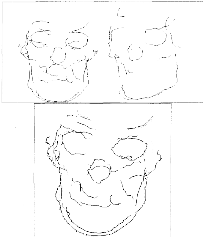
Figure 13. — a) En haut : Lignes de crêtes sur deux images scanner-X d'un crâne obtenues par le récent algorithme de J. P. Thirion et A. Gourdon [42]. b) En bas : Superposition des lignes de crêtes par notre algorithme en 7,7 secondes CPU sur un DEC 5900. 8 courbes sont identifiées sur respectivement 15 et 32. 53 points sont mis en correspondance sur 666 et 1124.
