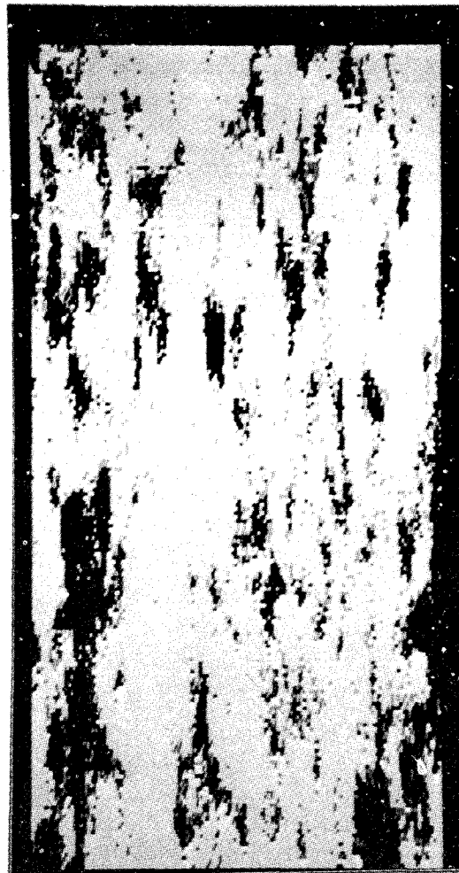
Fig. 3. — Cartographie binaire du fond marin. Les zones de fort relief sont représentées en noir. Les zones accessibles au robot sont représentées en blanc.
