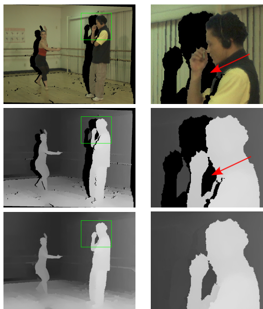
FIGURE 1 – Illustration d’un problème de restauration de fond : Le trou (pointé par la flèche rouge) n’est entouré que de pixels de premier plan. Haut : image d’intensité synthétisée, milieu : carte de profondeur synthétisée, bas : carte de profondeur restaurée avec notre méthode.
