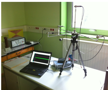
Figure 5: Antenne acoustique (4 capteurs)
