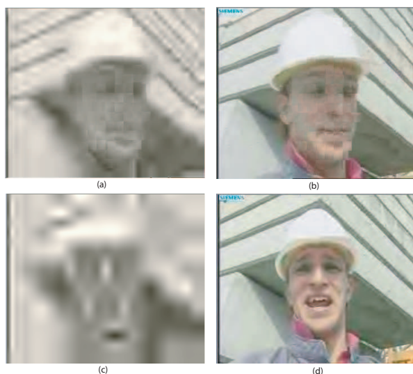
FIG. 5 – Séquences reconstruites “Foreman”, format CIF à 150 Kbps, trois niveaux de décomposition ; images 3 et 57 ; à gauche : vecteurs au quart de pixel codés sans perte ( R_v = 143.4 Kbps) ; à droite : vecteurs quart-pixéliques quantifiés à R_v^* = 48.5 Kbps et allocation optimale de débit.
