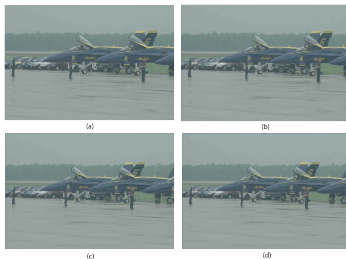
FIG. 6 – Séquences reconstruites “Jets”, format HD 720p ; images 14 et 59 ; à gauche : vecteurs pixéliques codés sans perte, R_t = 1.3 Mbps ( R_v = 766.5 Kbps) ; à droite : vecteurs pixéliques quantifiés à R_v^* = 357.5 Kbps et allocation optimale de débit utilisée avec R_t = 1 Mbps ; pSNR = 35.9 dB dans les deux cas.
