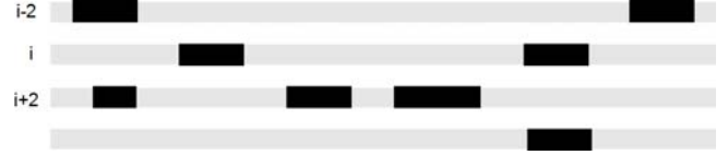
FIG. 3 – En noir, les segments de minima extraits à partir de la figure 2. Les lignes grises sont connues, les lignes blanches sont à interpoler
