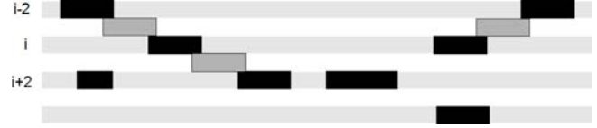
FIG. 7 – Les segments en gris foncé représentent les pixels de maxima interpolés grâce aux segments connexes noirs
