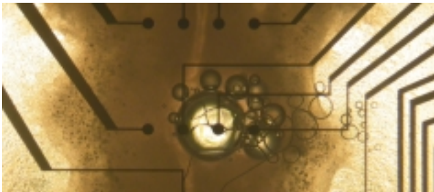
FIG. 5 : dégagement d'O 2 dû à un courant de fuite continu de 500 nA appliqué pendant 30 min sur une moelle épinière de souris de 12 jours embryonnaires mise en culture pendant 7 jours sur une matrice Ayanda au LNR
