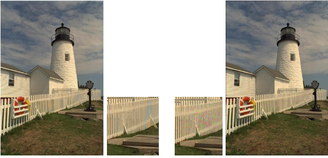
FIG. 3 – Exemple d’images reconstruites à partir de la grille régulière de Bayer (à gauche) et d’une grille irrégulière (à droite). On relève de types d’artefacts différents.
