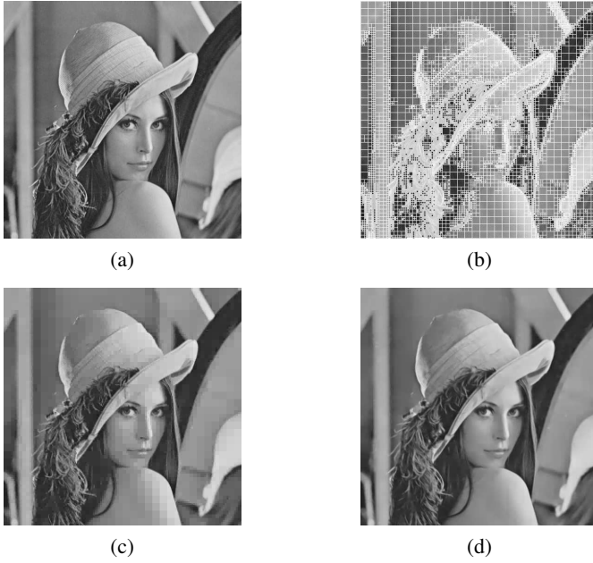
FIG. 1 – (a) Image originale (b) Grille (0.032bpp). (c) Image basse résolution (0.4bpp) - Première descente de pyramide. (d) Image post-traitée.
