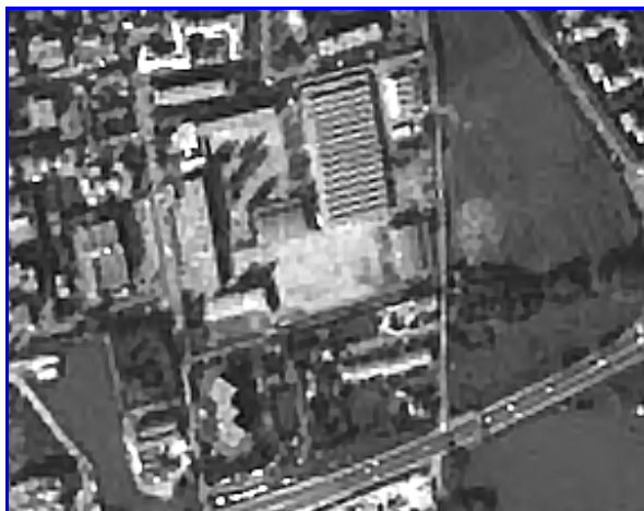
Figure 4 : déconvolution de l'image de la figure 3 en utilisant une méthode semi-quadratique [8]
