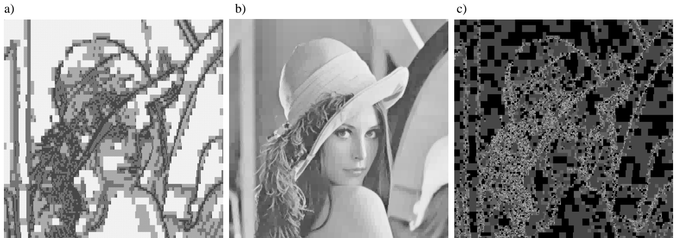
FIG. 2 : Lena 512x512 compressée par la méthode LAR : a) image des tailles (16x16 en blanc, 2x2 en noir), 13888 carrés b) image reconstruite par la luminance moyenne quantifiée, c) erreur de quantification (multipliée par 15)
