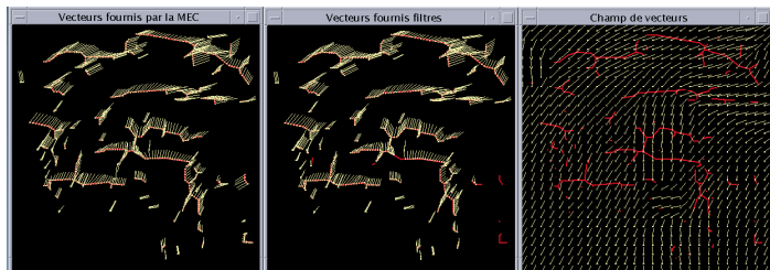
Fig. 4 : résultat d'appariement fournissant le champ de vecteurs lacunaire & interpolation du champ dense
