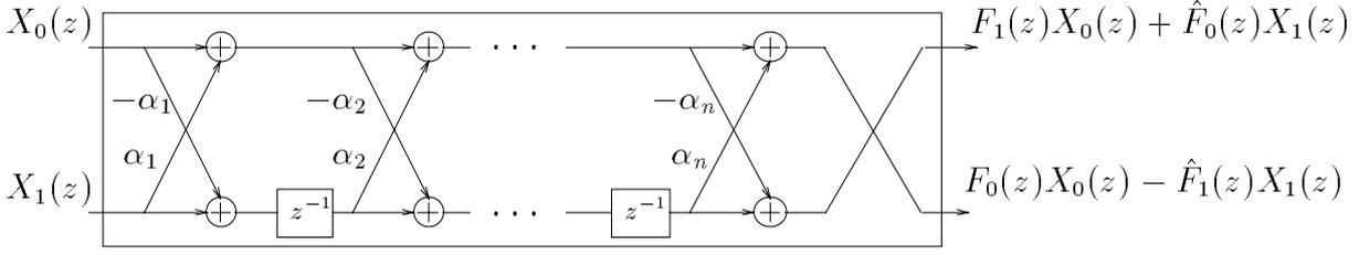
FIG. 2 – Structure treillis à sorties inversées.
