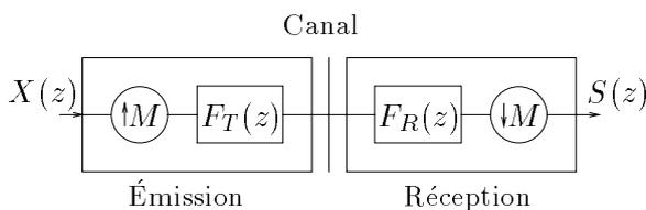
FIG. 1 – *Système de communication à facteur de suréchantillonnage égal à  $M$ .*
