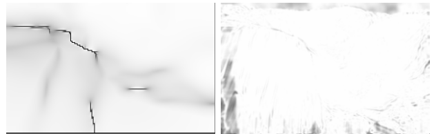
FIG. 4: Cartes de discontinuité et d'observation : plus le pixel est noir plus le poids associé est faible.
