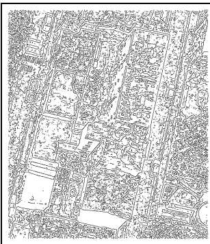
Détection de contours. Filtre de Deriche : \alpha = 2.5
