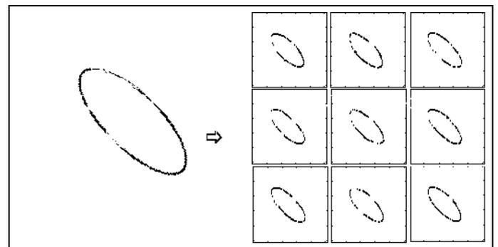
FIG. 2 — Décomposition d'une image binaire par sous-échantillonnage spatial (ordre 3)
