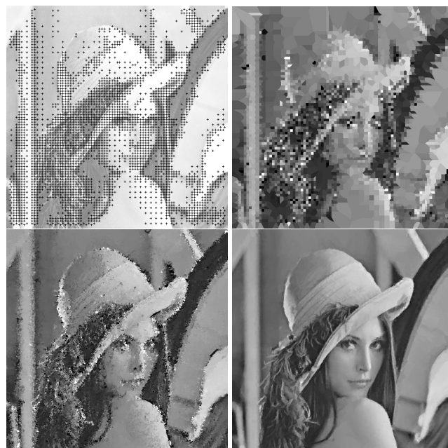
FIG. 4 — Itérations successives illustrant le décodage par fractales basées sur une partition de Voronoï : Partitionnement de l'image en 2906 polygones (représentation des seuls germes de la partition), 1 ère et 3 ème itérations, puis 7 ème (dernière) itération : PSNR=32.4db.
