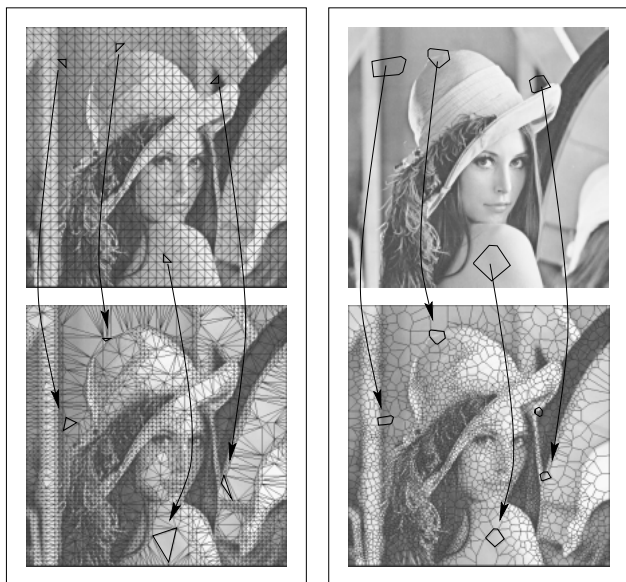
FIG. 6 — Principes de collage. A gauche : deux triangulations de Delaunay. A Droite : une seule polygonalisation de Voronoï.
